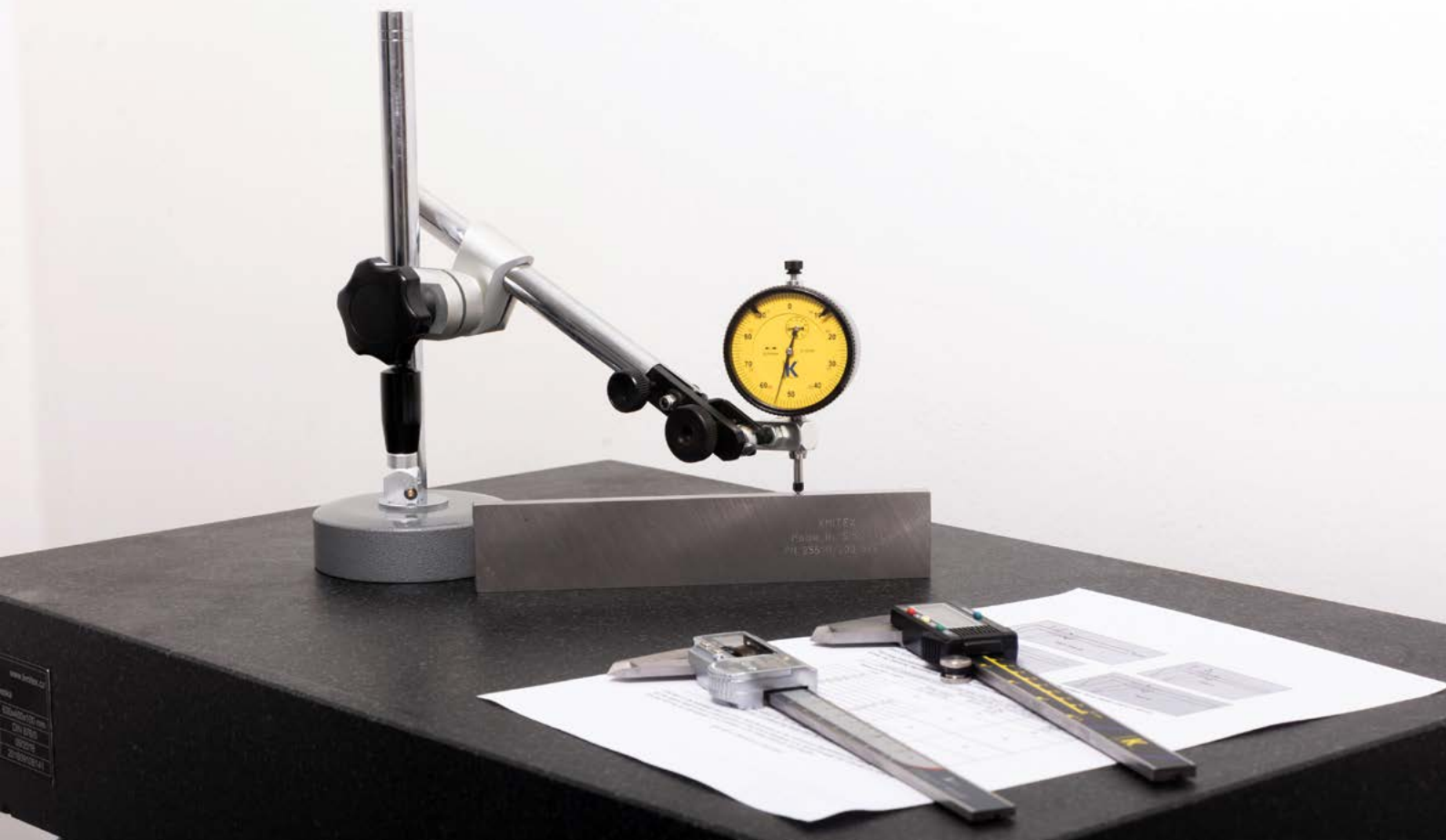
Prímerná doska granitová, DIN 876, jemne lapovaná diamantom
